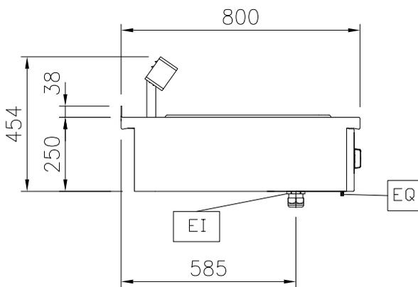
EI = Conexión eléctrica (energía)
